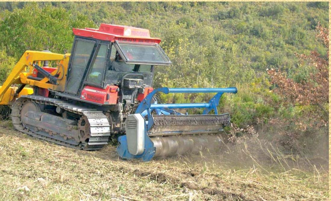
trituradora tbf con motor hidráulico sobre tractor caterpillar
